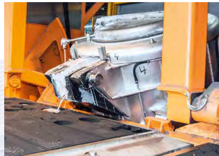
| Gießautomat mit elektrisch beheiztem Gießtiegel
